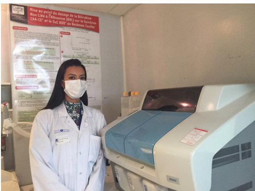
Dounia Aissa, technicienne, devant l'automate de biochimie (Indiko) qui réalise les dosages de bilirubine
